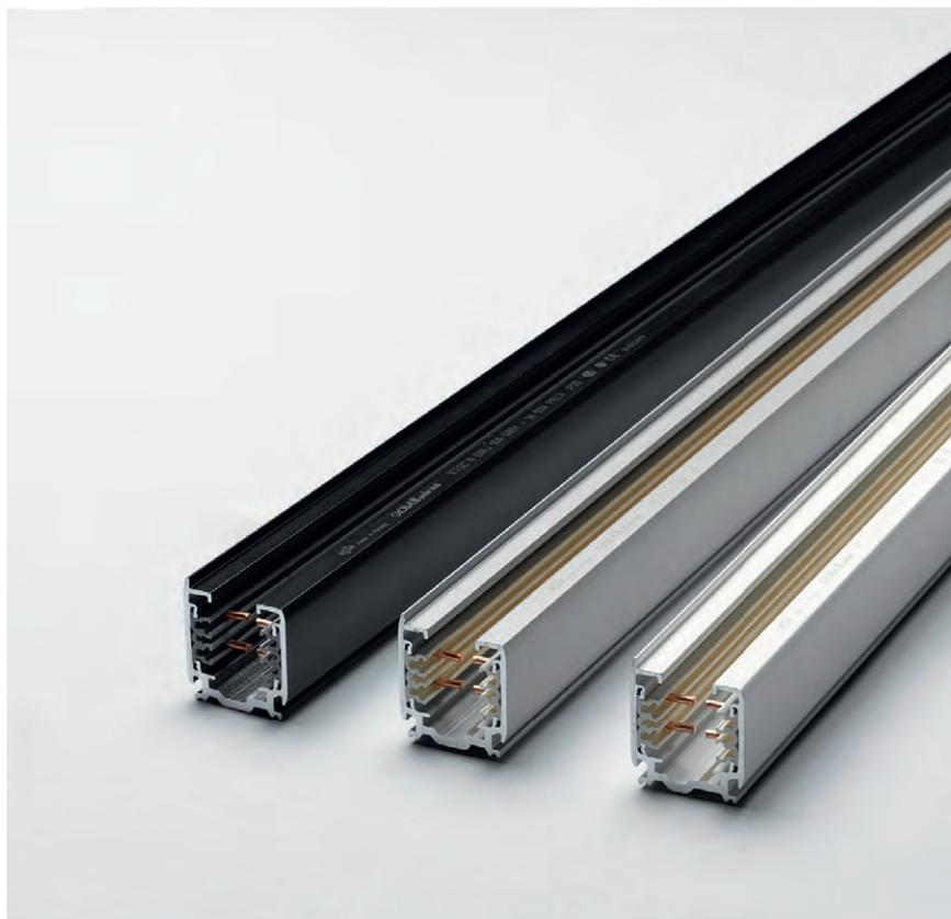
Die 3-Phasen-Stromschiene DALI eröffnet Ihnen einzigartige Möglichkeiten der flexiblen und individuellen Ansteuerung von Leuchten. Zusätzlich zu den vier elektrischen Leitern verfügt die Schiene über zwei weitere für die Steuerungssysteme DALI, EIB, LON und 1-10 V. Das Stromschiensensystem ist ideal für flexible Beleuchtungssituationen - schaffen Sie in Ihren Verkaufsräumen eine besondere Atmosphäre und profitieren Sie gleichzeitig von den großen Einsparpotentialen Ihrer Energiekosten.
